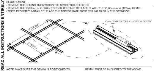
NOTE: MAKE SURE THE GEMINI IS POSITIONED TO ALLOW THE CORRECT PLACING OF THE SURROUNDING GRID AND TILES.
