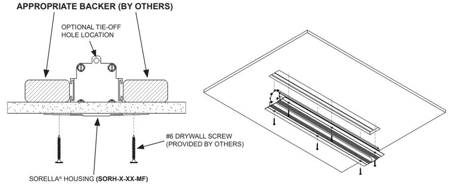
3. TAPE AND PLASTER AROUND THE HOUSING, ENSURING A SMOOTH SURFACE FINISH.
